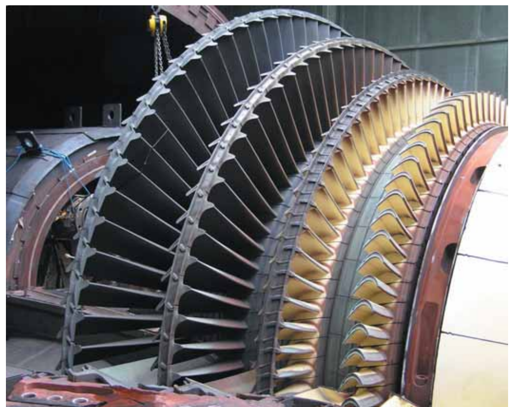
La turbine à gaz entraîne le générateur électrique fournissant 260 MW, soit 65% de la puissance totale de la centrale. Photo LDD
